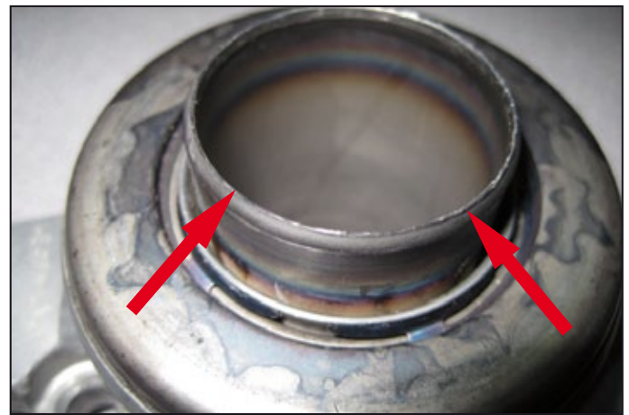
Fig. 2: Anillo tope del actuador desgastado por montaje de disco al revés.
