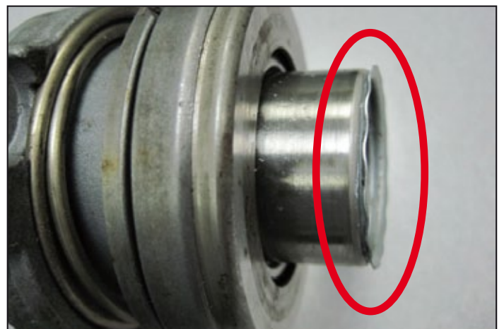
Fig. 7: Anillo tope deformado por exceso de recorrido.
