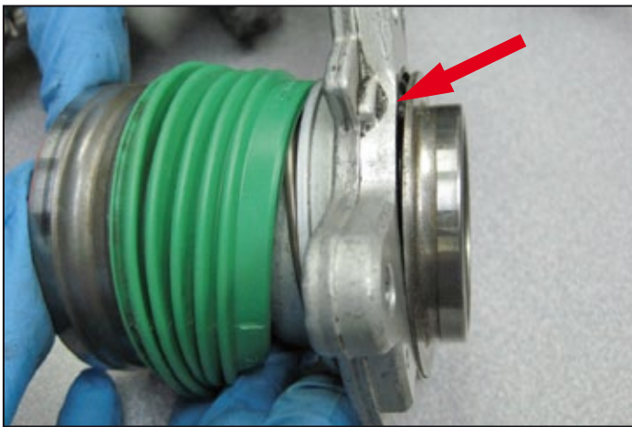
Fig. 6: Actuador desmontado por alojamiento incorrecto en su posición.
