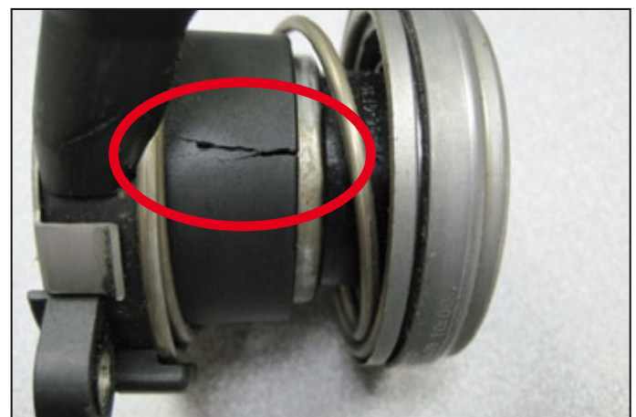
Fig. 3: Actuador fracturado por defecto de montaje.
