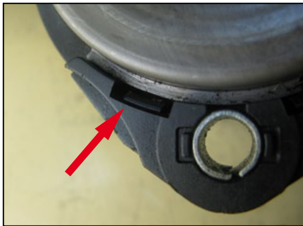
Fig. 1: Espiga plástica dañada por ajuste desparejo. Recomendamos ajustar en cruz y progresivamente.
