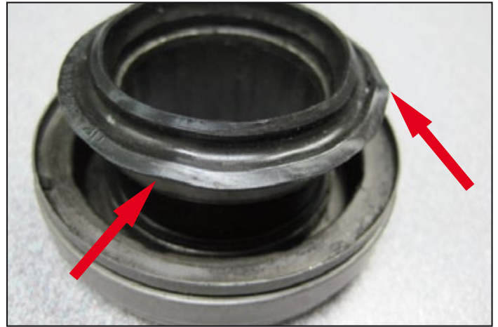
Fig. 5: Retén interno dilatado por contacto con líquido incompatible.
